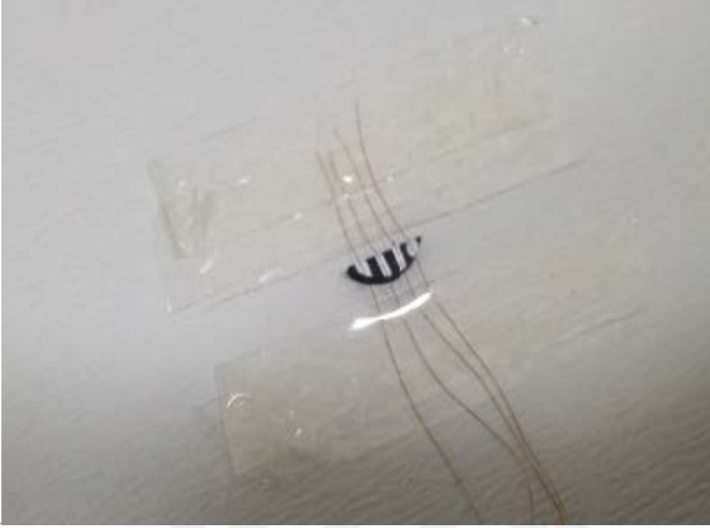
Resim 3.3. Sıcaklığa bağlı elektriksel direnç ölçümü için hazırlanan numune
