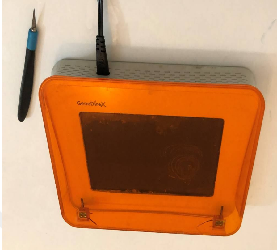
Şekil 3.2. Transillumination Cihazı (GeneDireX).
