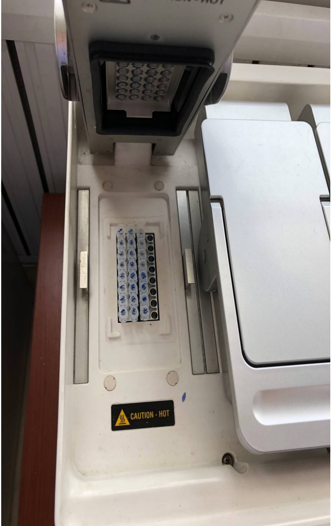
Şekil 3.19. PCR cihazında numunelerin çalışılması.
