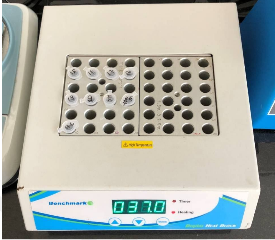
Şekil 3.11. Numunelerin ısı bloğunda bekletilmesi.
