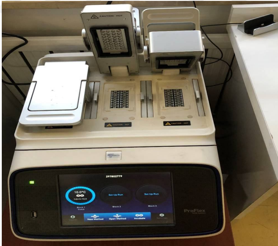
Şekil 3.3. PCR cihazı (Applied Biosystems ProFlex).
