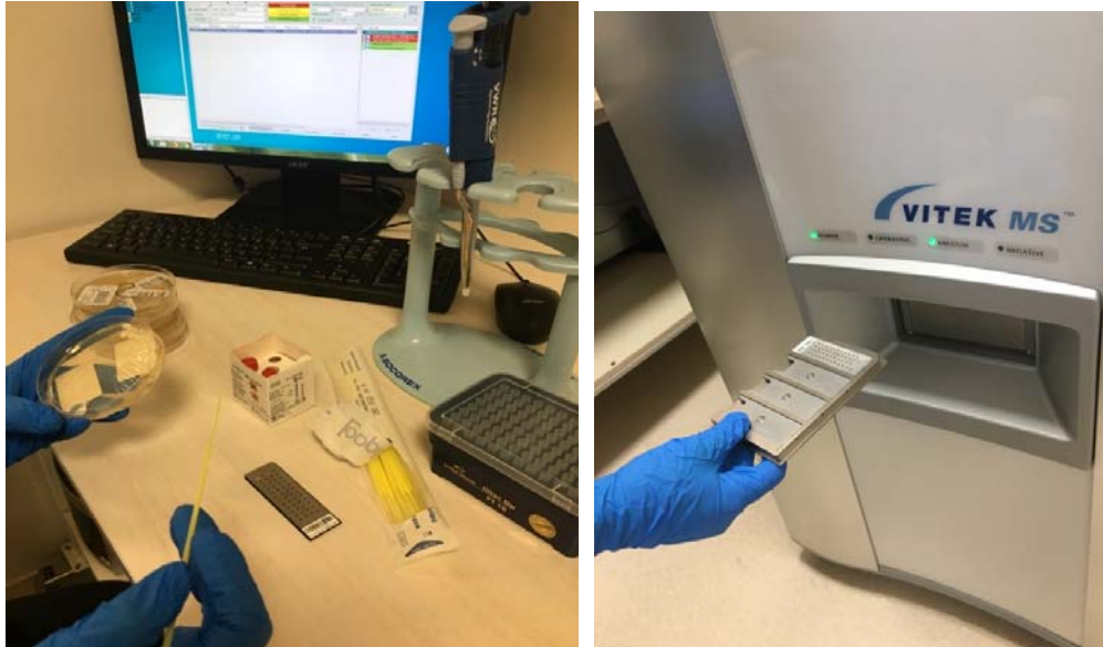
Resim 5: MALDI-TOF MS System çalışma yöntemi
