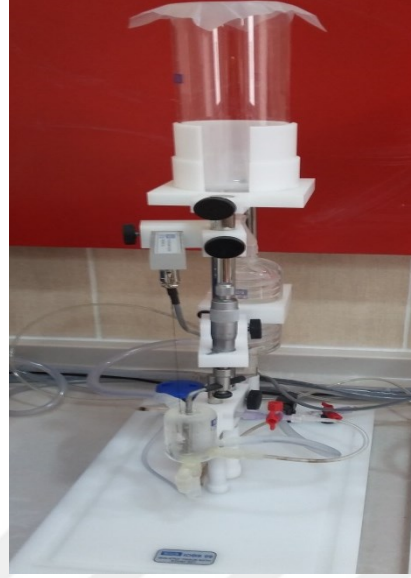
Şekil 3. 2 İzole organ banyosu sisteminin haznelerinden biri
