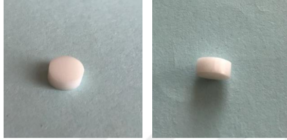
Şekil 3. 1. Zirkonyum Örneğin Tasarımı ve Ölçüleri (7 mm çap, 3 mm genişlik)
