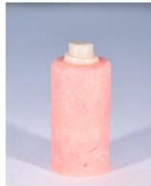
Resim 3. 16. Kompozit Resinin Polimerize Edilmesi ve Örneğin Son Hali
