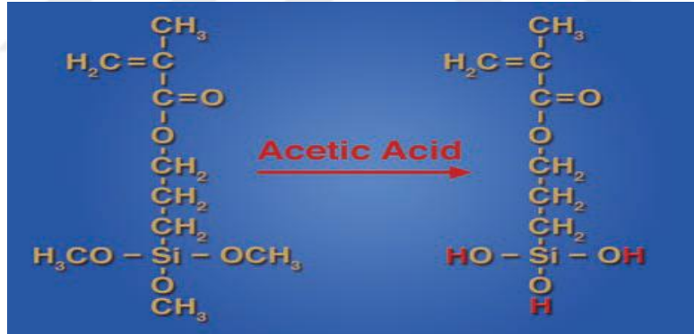
Şekil 2. 3. Asetik Asidin Silan Bileşiğine Etki Mekanizması (Gary 2008)
