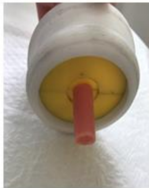
Resim 3. 16. Kompozit Resinin Polimerize Edilmesi ve Örneğin Son Hali
