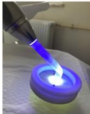
Resim 3. 16. Kompozit Resinin Polimerize Edilmesi ve Örneğin Son Hali
