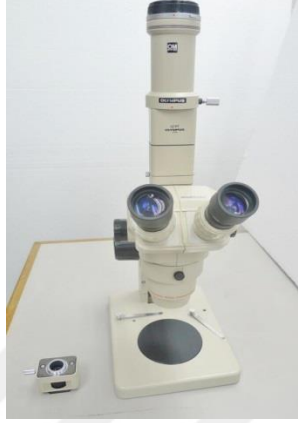
Resim 3. 19. Kırık Örneklerin Görüntülediği Stereo Mikroskop
