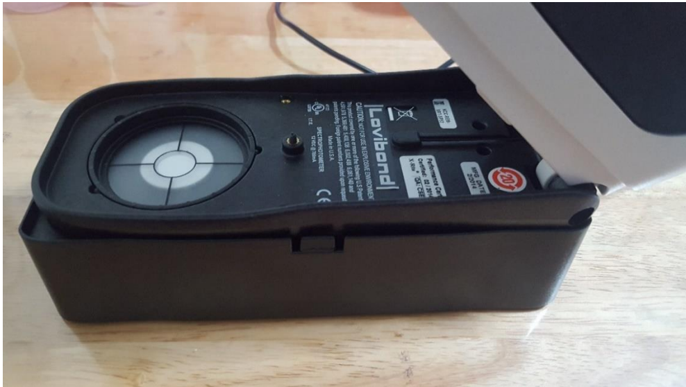
Şekil 34: Lovibond RT Series Spektrofotometre ile renk ölçümü yapılışı gösterimi
