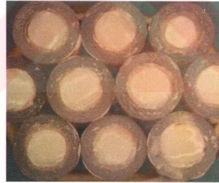
Resim 3.b: Şeffaf poliakrilik çubuklara yerleştirilmiş mine örneklerinin yüzey görünümü
