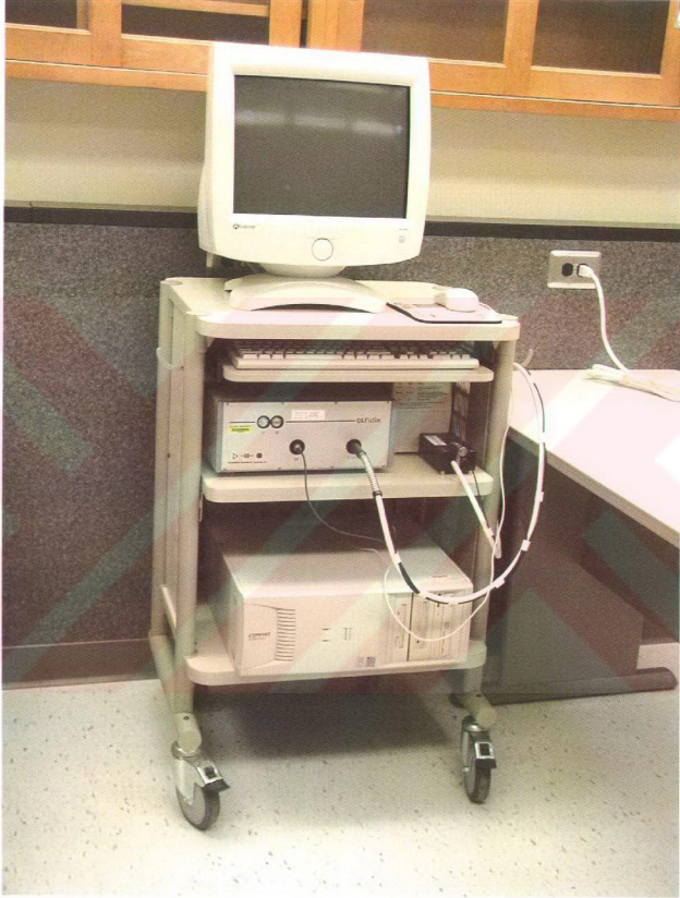
Resim 4: Çalışmada kullanılan Quantitative Light-Induced Fluorescence cihazı
