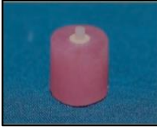
Şekil 3.15. Bağlanma Dayanımı Testi İçin Hazırlanan Örnek
