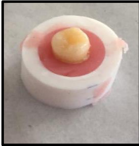
Şekil 3.12. Dişlerin Akrilik Bloklara Gömülmesi
