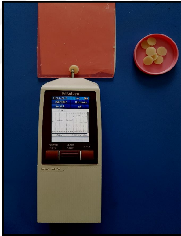
Şekil 3.5. Yüzey Pürüzlülüęü Ölçümünde Kullanılan Profilometre Cihazı
