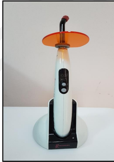
Şekil 3.4. Örneklerin Polimerizasyonu İçin Kullanılan LED.B Polimerizasyon Cihazı
