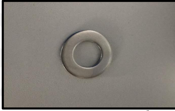
Şekil 3.17. Renk Değişimi, Yüzey Sertliği ve Yüzey Pürüzlülüğü Ölçümleri İçin Örneklerin Hazırlanmasında Kullanılan Metal Kalıp
