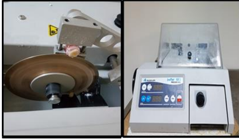
Şekil 3.13. Dentin Yüzeylerinin Açığa Çıkarılmasında Kullanılan Isomet Cihazı
