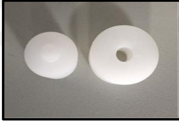
Şekil 3.7. Basma Dayanımı Örneklerinin Hazırlanmasında Kullanılan Politetrafloroetilen Kalıp
