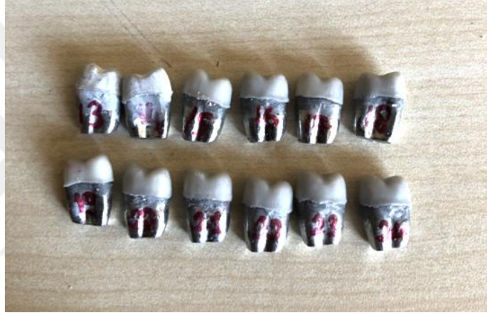
Şekil 5. Cr-Co dayanaklara yapıştırılmış PEKK alt yapılar
