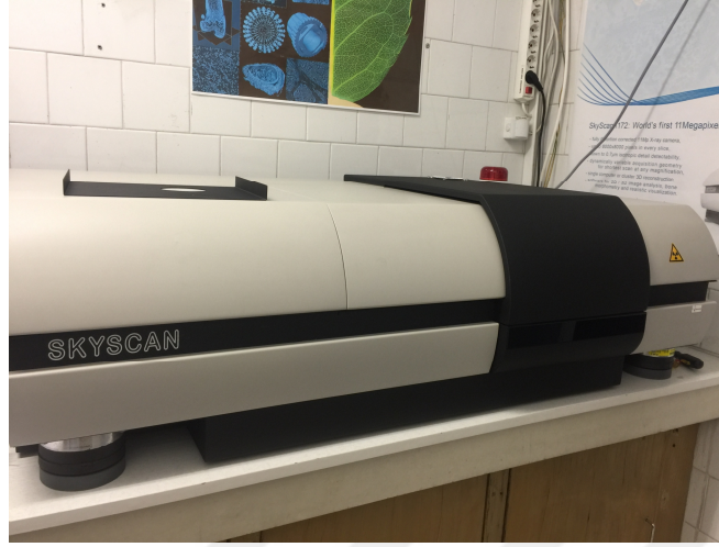
Şekil 23. Mikro BT cihazı.
