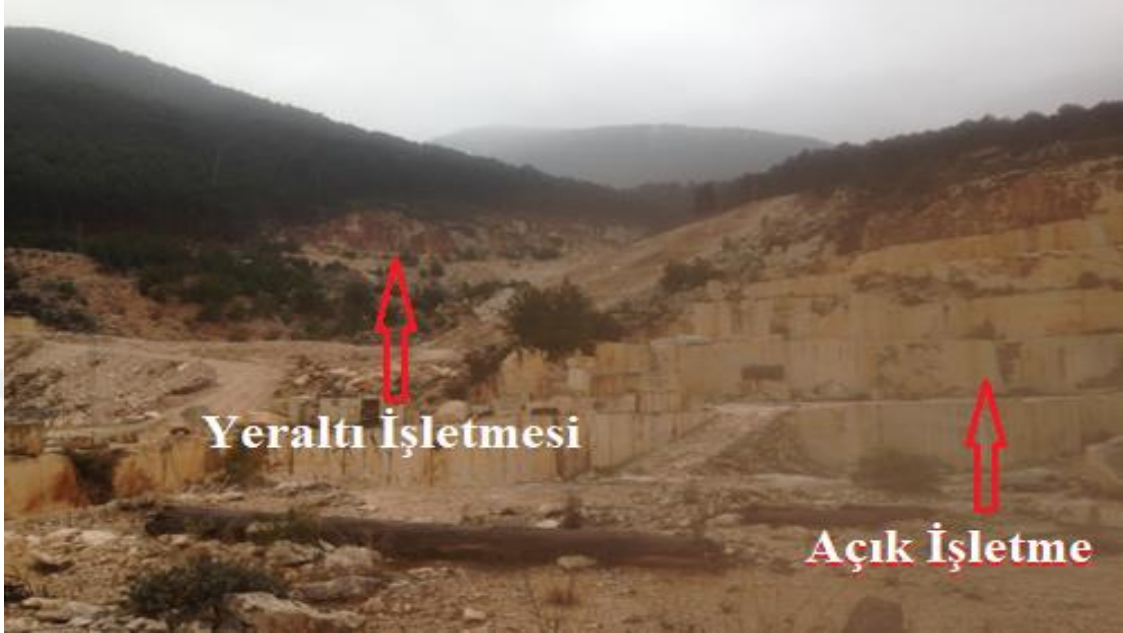
Şekil 1.5. Çalışma alanında daha önce yapılmış olan ve terk edilmiş açık işletme ve yeraltı işletmesinin yapıldığını gösteren fotoğraf
