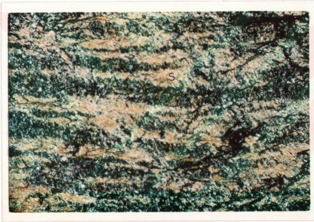
Şekil 4.18: Fillitlerde birbirlerine paralel olarak uzanan klorit (K) ve serisit (S) minerallerinin görünümü. (çap nikol, x 40 numune no: 12).
