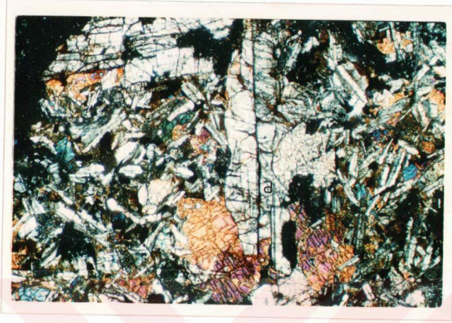
Şekil 4.40: Diyabazlarda plajiyoklaz (P) minerallerinin birbirine dayanmasıyla oluşan doleritik doku. Pr: Piroksen. (çap nikol, x 100 numune no: 63).
