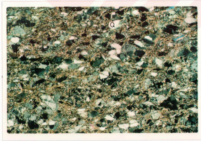
Şekil 4.17: Kuvars serisit şistlerde serisitlerin içinde yüzer gibi gelişigüzel dağılmış kuvars (Q) ve feldispat (F) minerallerinin görünümü.(çap nikol, x 40 numune no: 48).
