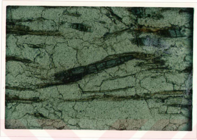
Şekil 4.29: Granatlı mikaşıstlerde izlenen glokofan minerallerinin görünümü. (Tek nikol, x 100 numune no: 96-101).
