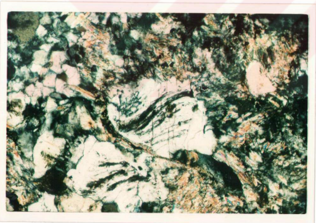
Şekil 4.6: Feldispatlar içindeki, şiştözitenin ondülasyonuna uygun opak mineral inklüzyonları. (çap nikol, x 100 numune no: 220).
