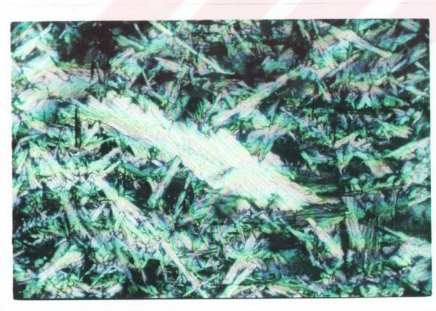
Şekil 4.36: Serpantinitler içindeki klinoklor mineralinin görünümü. (çap nikel, x 100 numune no: 223).
