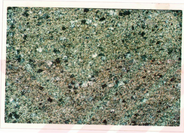
Şekil 4.19: Kuvars fillitlerde serisit mineralleri içinde albit ve kuvars minerallerinin görünümü. (çap nikol, x 20 numune no: 11).
