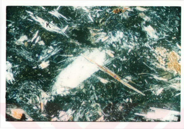
Şekil 4.20: Epidot – aktinolit şistlerde klinoklorları (K) keser şekilde aktinolit (Ak) minerallerinin görünümü. (çap nikol, x 100 numune no: 250a).
