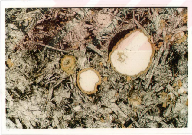
Şekil 4.44: Bazaltlardaki boşluklar etrafında gelişen kloritleşmelerin görünümü. (Tek nikol, x 400 numune no: 96-56).
