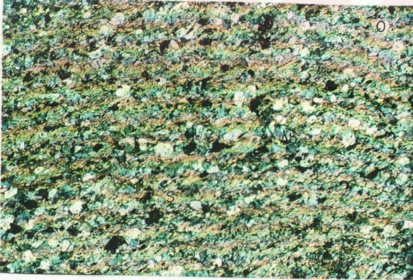
Şekil 4.15: Serisit - kuvarşistlerde serisit (S) ve kuvars (Q) minerallerinin görünümü. (çap. nikol, x 40 numune no: 52).
