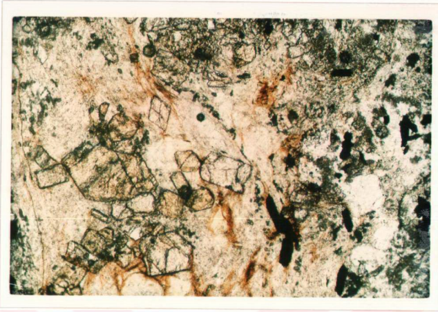
Şekil 4.9: Kloritşişterlerde, altıgen köşeli epidot minerallerinin görünümü. (Tek nikol x 100 numune no: 99)
