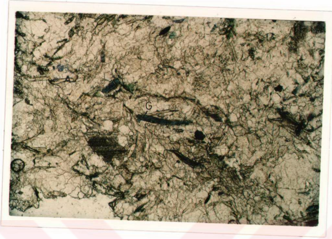
Şekil 4.32: Glokofanışitlerde izlenen glokofan (G), aktinolit (A) minerallerinin görünümü. (Tek nikol, x 40 numune no: 95).
