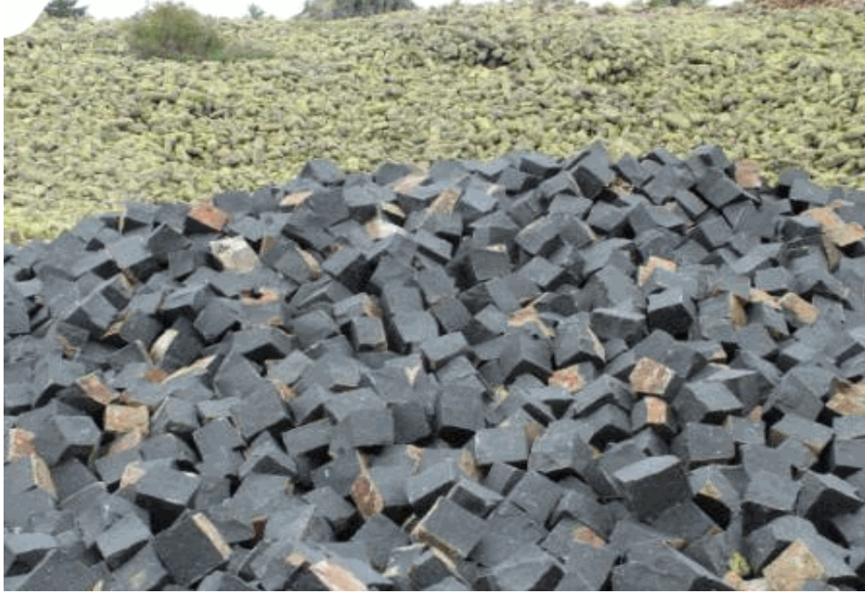
Şekil 15. Küp şeklinde kesilmiş bazalt taşlar.
