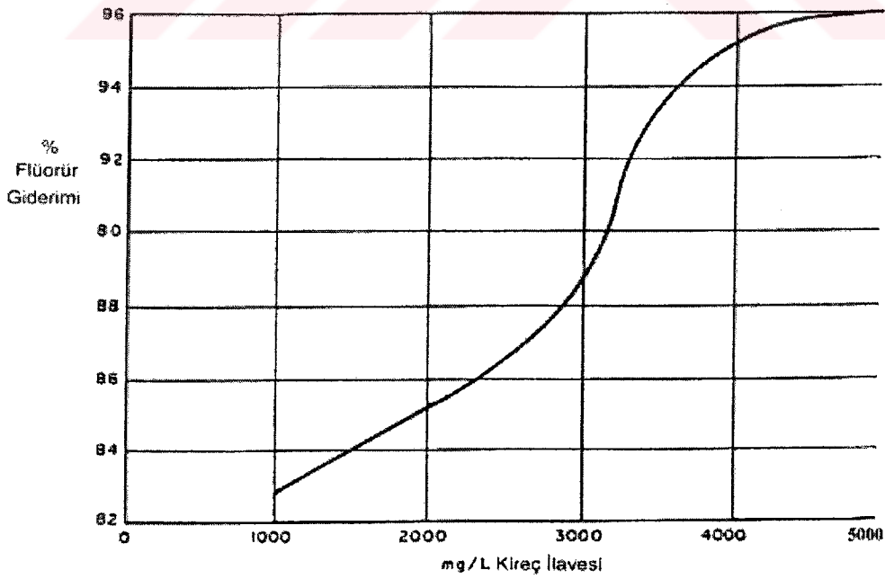
Şekil 2.26. Kalsiyumla florürün çökeltimi (Tuncer, 1989)
