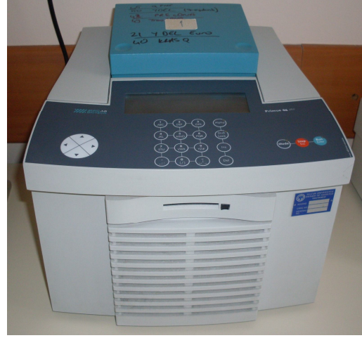
Şekil 15 : Olgularda MTHFR genindeki C677T ve A1298C bölgelerinin bulunduğu DNA segmentlerinin çoğaltılması için kullanılan ısı-döngü cihazı (Primus 96 plus, MWG AG Biotech, Almanya)
