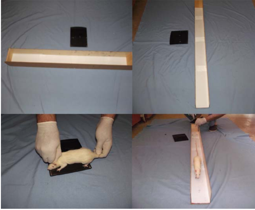
Şekil 20: Yürüyüş yolu analizi yapılan yürüme kulvarı
