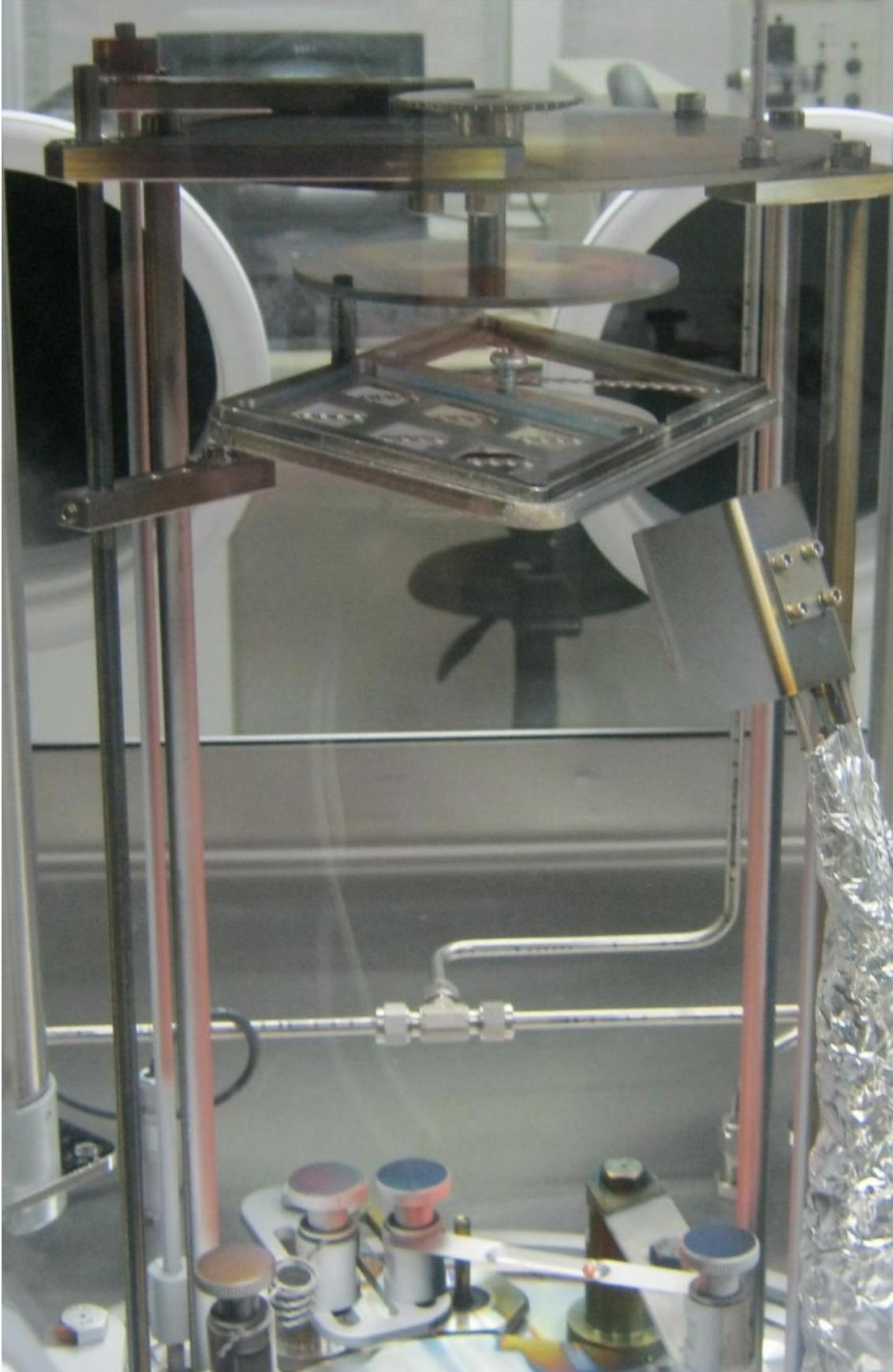
ekil 3.4: Termal evapulator cihazına mikroplakların ve inkonun yerle tirilmesi
