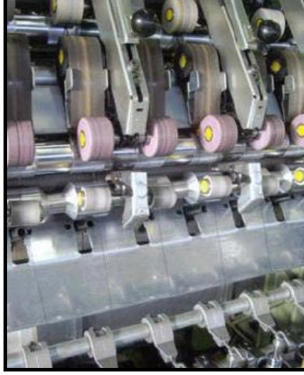
Şekil 1.29. MCS kompakt iplik egirme sistemi (Oxenham, 2003)
