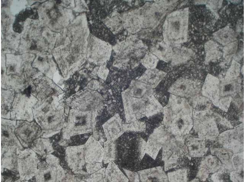
Foto 3.7. Katarası Formasyonu TSK-4 sondajında belirlenen intraklast seviyesi (Tek nikol, X10 )
