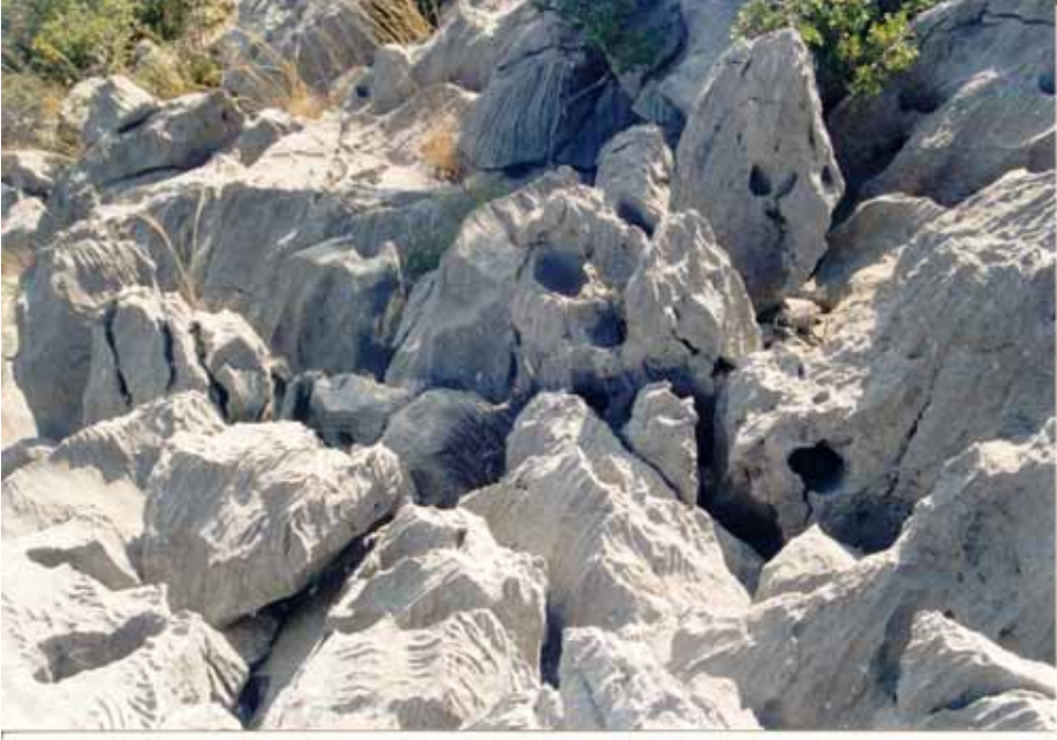
Foto 4.1. Tünel giriş bölgesindeki Katarası Formasyonu'nda gözlenen yüzeysel suların etkisi ile oluşmuş çözünme yapıları (Karren ve boşluklar)
