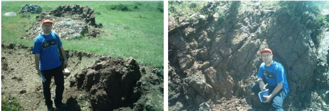
Şekil 4.51. Isparta ofiyolit karmaşığının ana litolojisini oluşturan radyolarit ve serpantinler (Lokasyon: GPS 292910E 4180374N, Savköy güneyi).
