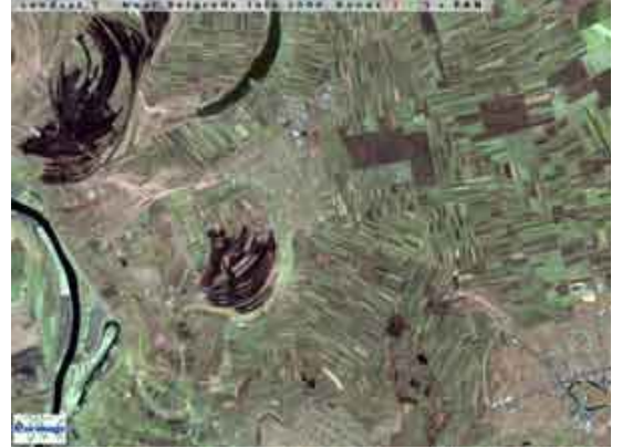
3 2 1 + Pan dođal renklerde grlen arazi 8 bant eklendikten sonra grntde bozulma olmadan daha detaylı incelenebilmektedir. znrlk 15 m.
