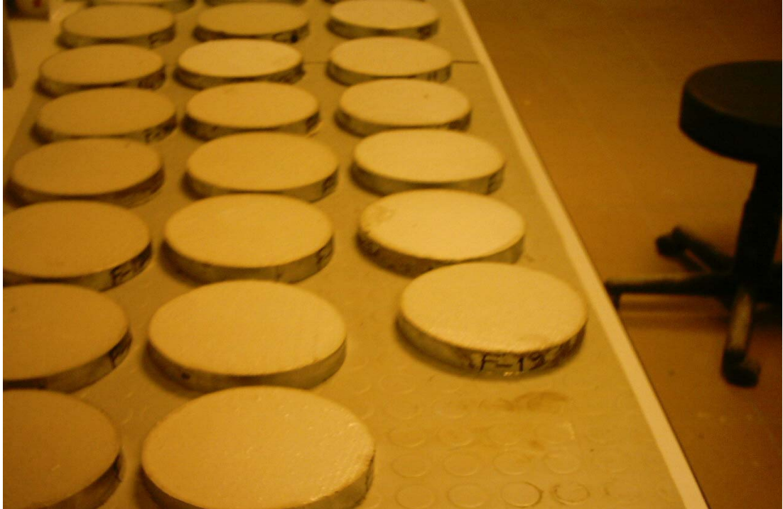
Şekil 3.2.4.2.1. Dairesel kalıplara dökülmüş harç numuneleri
