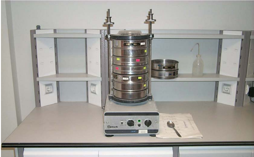
Şekil 3.1.5.1. Kalekim ar-ge laboratuvarında bulunan kuru elek analiz cihazı
