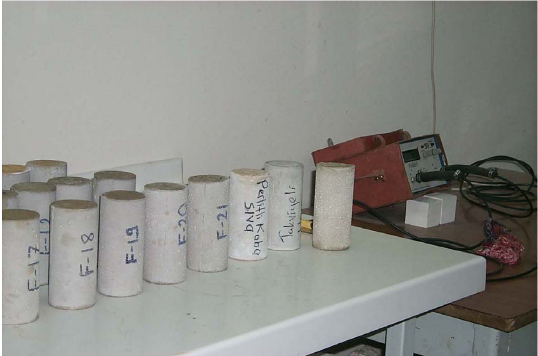
Şekil 3.2.7.1.1. Hazırlanan silindirik harç numuneleri ve pundit cihazı
