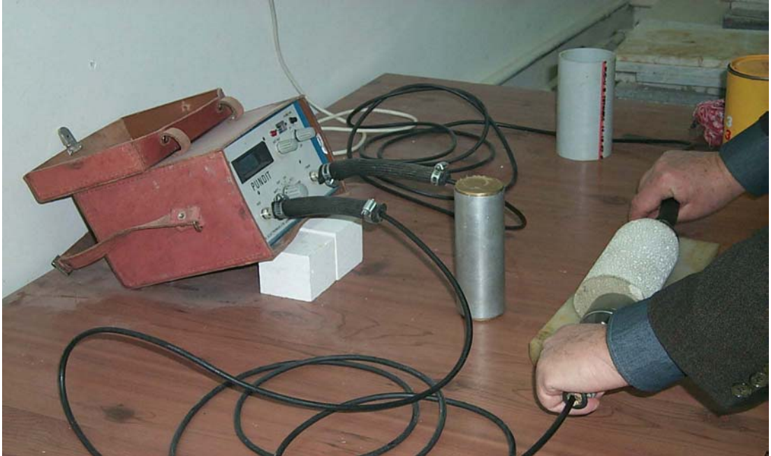
Şekil 3.1.13.1. S.D.Ü. İnşaat Müh. Laboratuvarındaki P dalga hızı ölçüm cihazı
