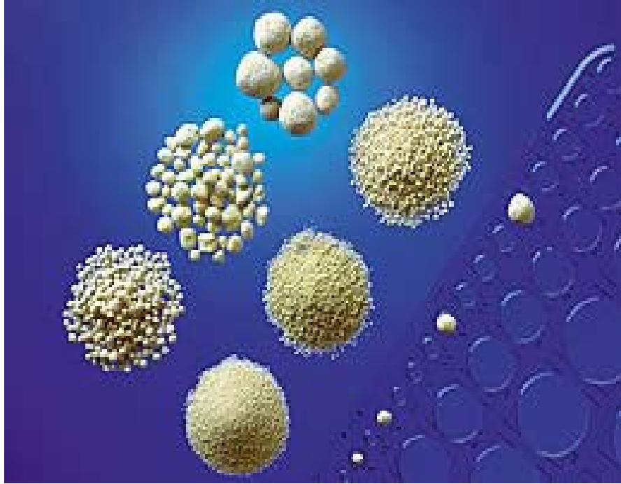
Şekil 2.5.2.2. Poraver soğutma prosesi sonrasında elenerek 6 değişik boyutta sınıflandırılır (Poraver, 2003)
