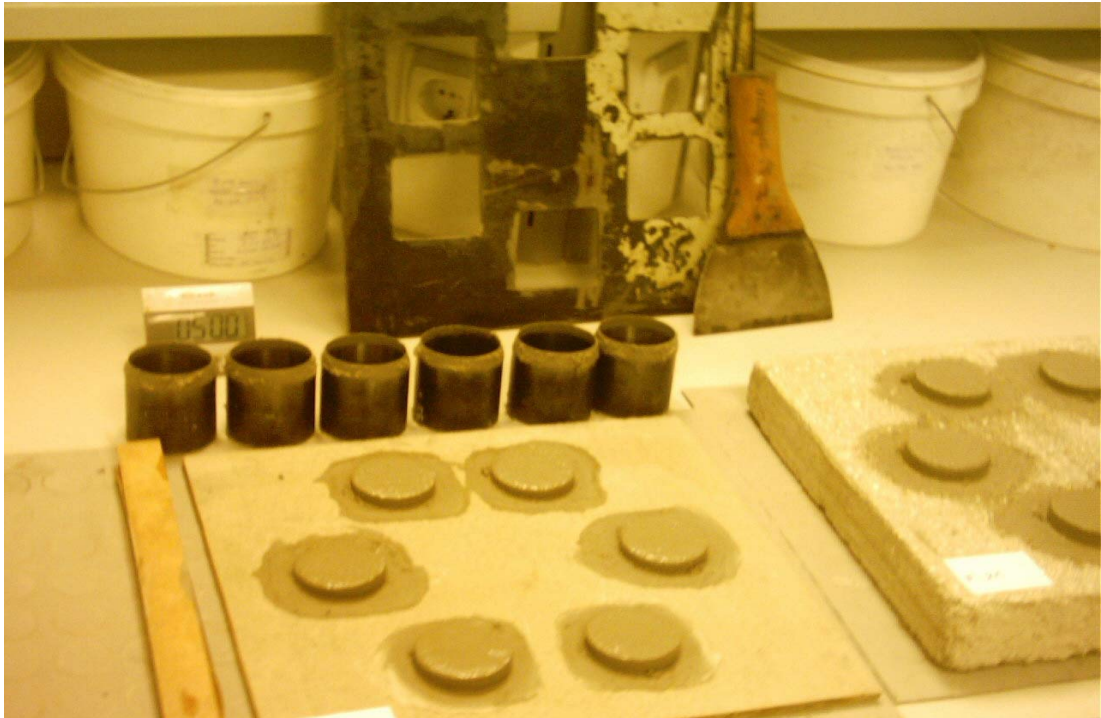
Şekil 3.2.5.3.1. Asbestli plaka üzerine hazırlanmış harç numunesi ve metal kovanlar
