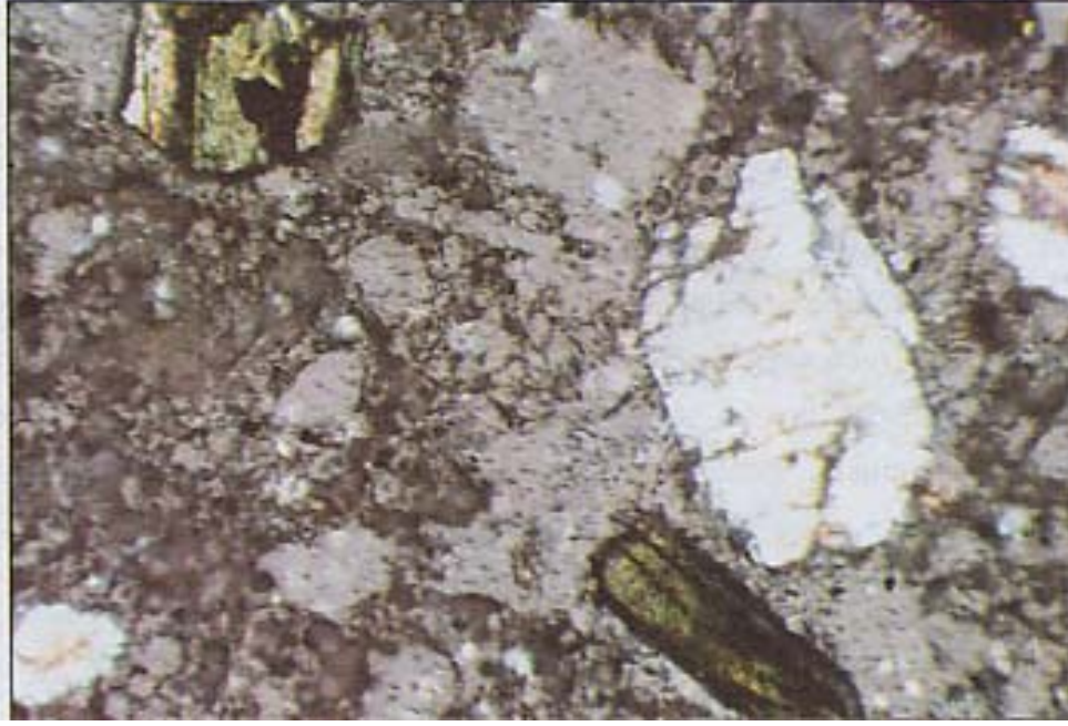
Şekil 2.1.8.4.3. Doruk bölgesi pomzasının ince kesit görünümü (Gündüz vd.,1998)
