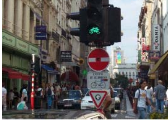
Şekil 3.8 Kavşaklarda Bisiklet Sinyallerinin Uygulanması
