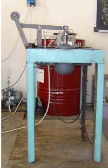
Şekil 3.9. Aşınma test düzeneği
