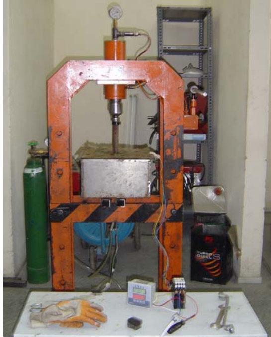
Şekil 3.1. Sıcak pres deney düzeneği
