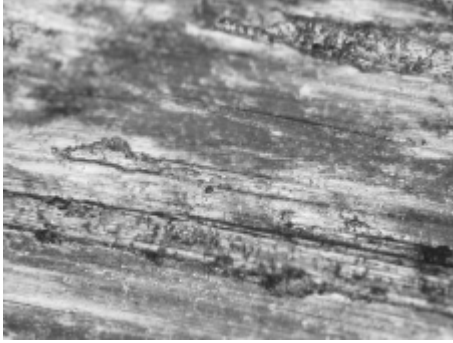
Şekil 4.33. Al-% 5 Cu-%10 B 4 C×200(Yaşl.) Şekil 4.34. Al-% 5 Cu-%10 B 4 C×200
