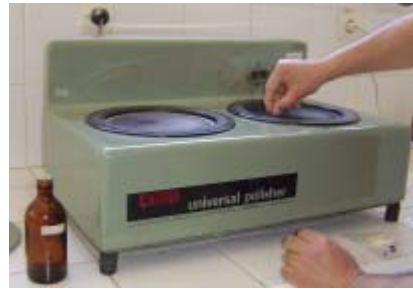
Şekil 3.16. Elmas suyu ile parlatılması
