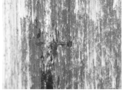
Şekil 4.33. Al-% 5 Cu-%10 B 4 C×200(Yaşl.) Şekil 4.34. Al-% 5 Cu-%10 B 4 C×200
