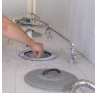
Şekil 3.15. Alumina tozu ile zımparalama
