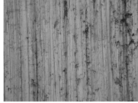
Şekil 4.27. Al-% 5 Cu-%10 SiC×200 (Yaşl.) Şekil 4.28. Al-% 5 Cu-%10 SiC×200
