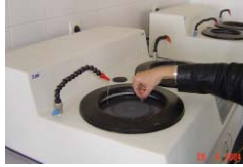
Şekil 3.14. Cihaz ile zımparalama
