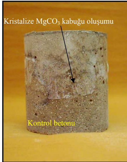
Şekil 4.60. Beton örneklerinde \text{MgCO}_3 çiçeklenmesi ve kristalize kabuk oluşumu
