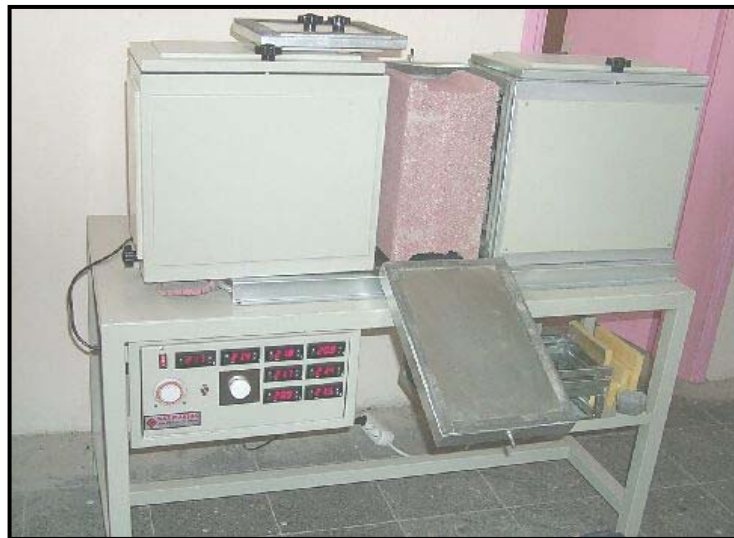
Şekil 4.89. Isı iletkenlik test cihazı ile blok örneğinin analizinden görünüm
