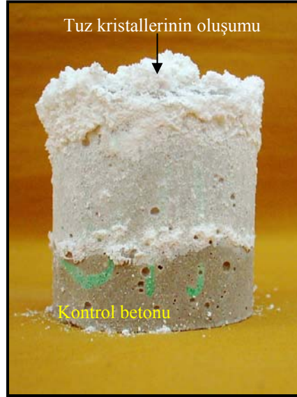
Şekil 4.59. Beton örneklerinde \text{Na}_2\text{SO}_4 çiçeklenmesinin oluşumu
