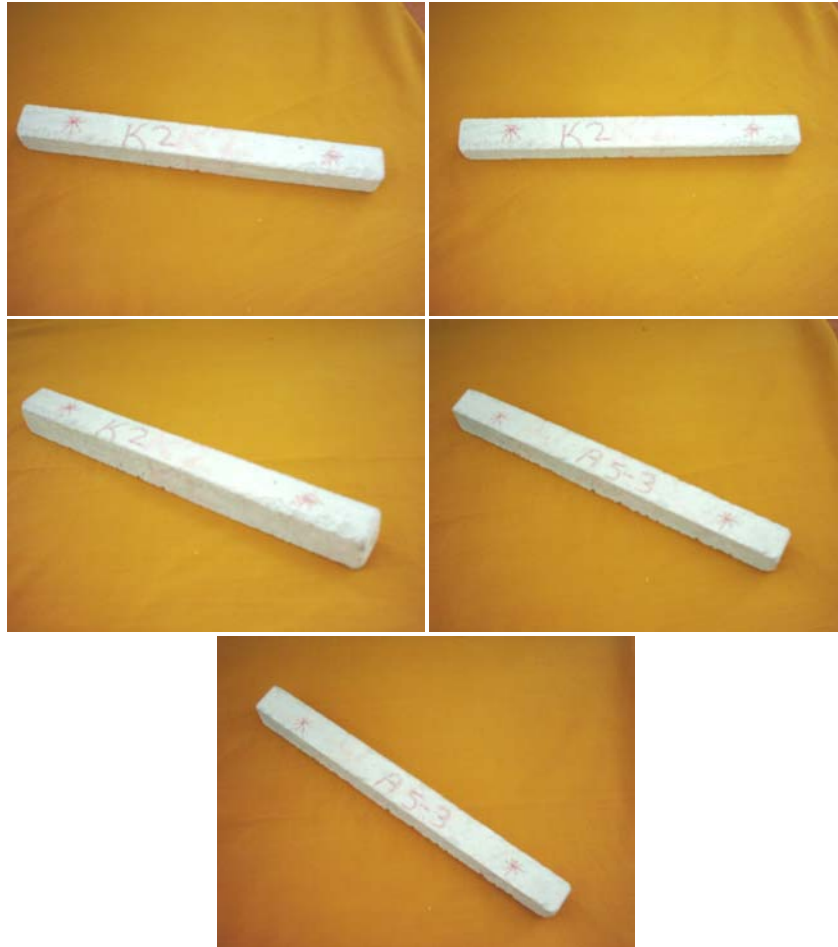
Şekil 4.44. Karışım tasarımını temsil eden 25 x 25 x 279 mm prizmatik çubuklar
