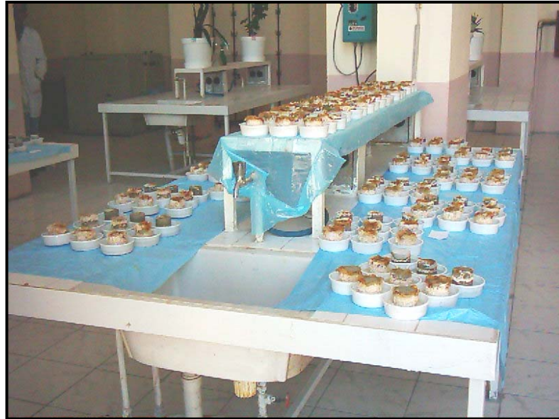
Şekil 4.73. Asidik çözelti - beton örneği etkileşimi deney ortamı
