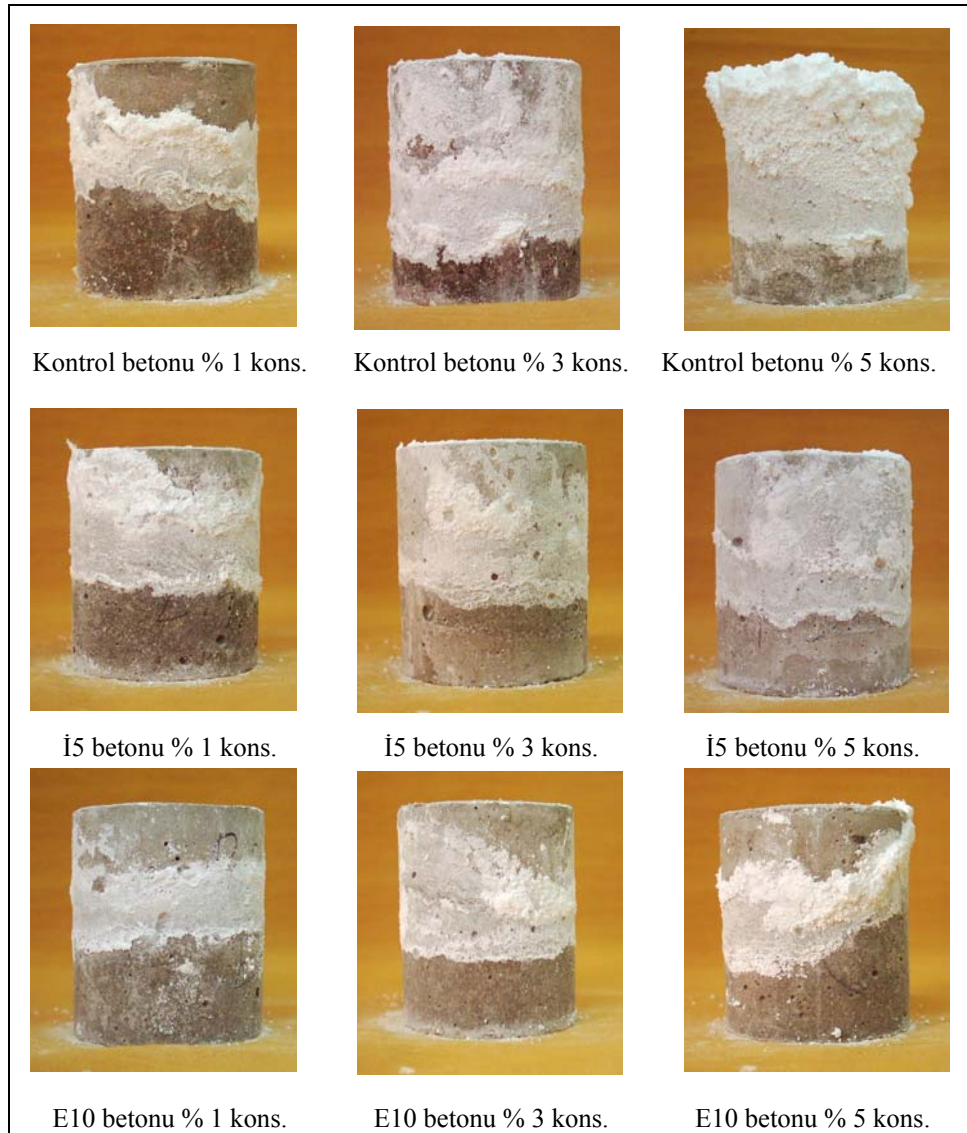
Şekil 4.63. \text{Na}_2\text{SO}_4 çözeltisi ile etkileşen C40 sınıfı beton örneklerinin yüzeyinde oluşan sülfatlı tuzlar
