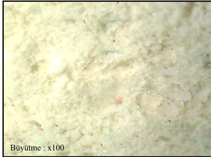
Şekil 4.48. % 5 Amorf silika kullanımı ile ASR etkisinde betonda yüzeysel bozunma
