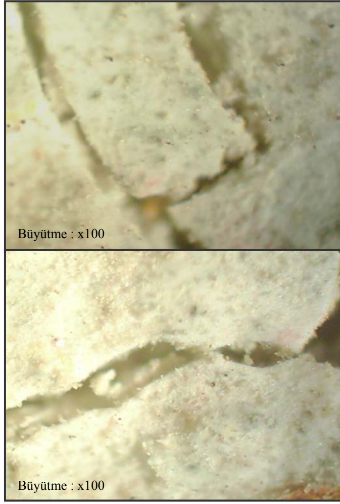
Şekil 4.47. ASR etkisinde kontrol betonunda yüzeysel olarak gelişen çatlak mekanizması
