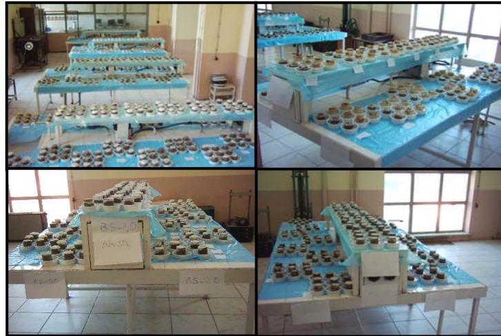
Şekil 4.58. Kimyasal çözelti - beton örneği etkileşimi deney ortamı
