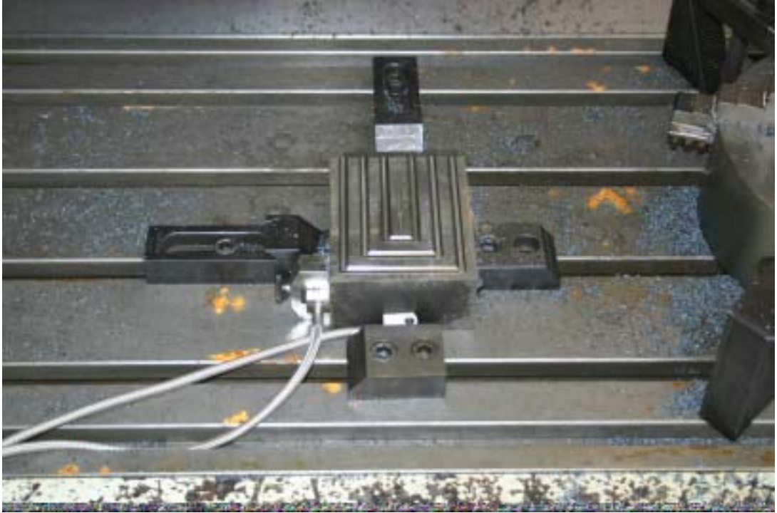
Şekil 6.8. İş parçasının tezgaha bağlanma şekli
