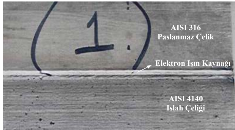
Şekil 8.1. 1.grup numunenin kaynak dikişinin üstten makroskobik görünüşü
