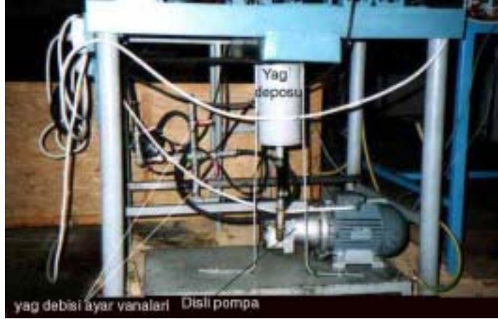
Şekil 5.6. Hidrolik donanım sistem (Tüfekci, 2002).
