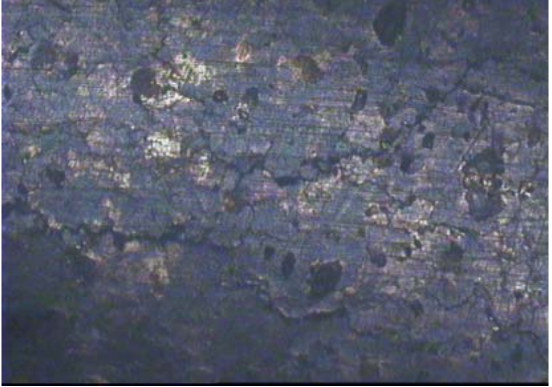
Şekil 6.70. Yataklarda ilk çatlakların oluşumu ilerlemesi (┆—┆12 μm)
