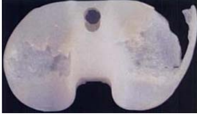
Şekil 18. Aşınmış Polietilen İnsert
