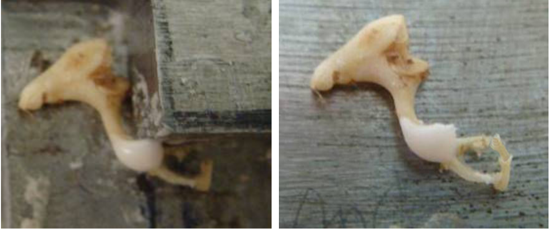
Resim 3: Bone cement ile bağlantının sağlanması ve düzenekten çıkarılması
