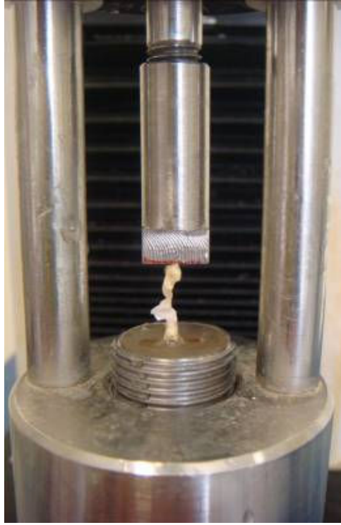
Resim 5: Kemikçiklerin düzeneğe yerleştirilmesi
