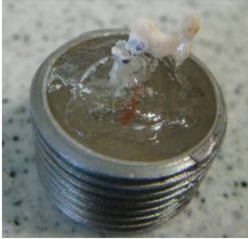
Resim 7: Ara yüzey ayrılmanın olduğu deney ve SEM fotoğrafı (yetersiz bağlantı)
