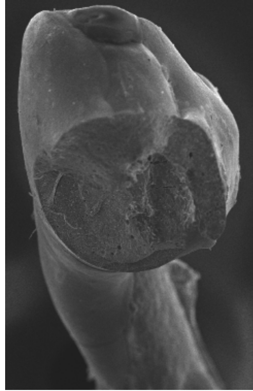
Resim 7: Ara yüzey ayrılmanın olduğu deney ve SEM fotoğrafı (yetersiz bağlantı)
