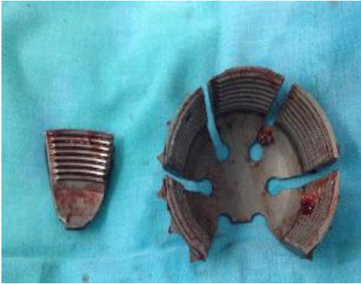
Resim 13-14. Revizyon sırasında ekspansif kap kanat kırığı ve polietilen insert görüntüsü
