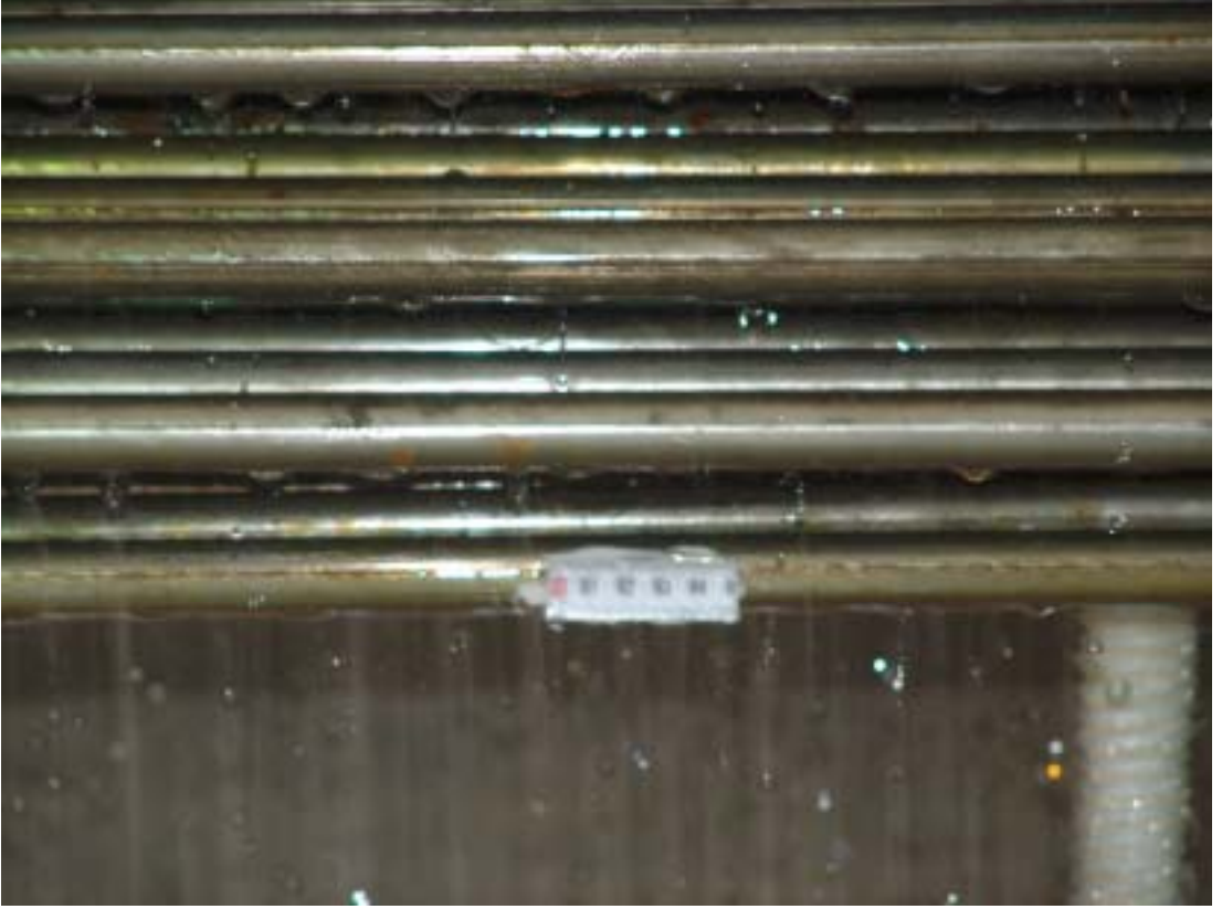
Ek 1.6. Serpantin borularındaki su akışı ve çalışma bölgesindeki damlalar.
