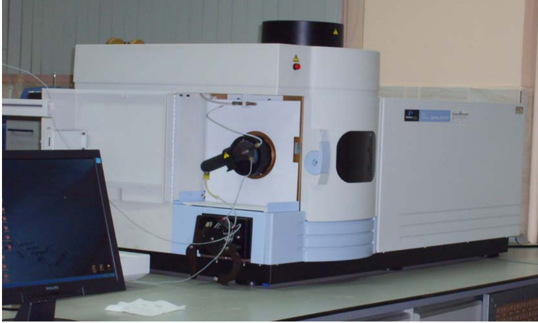
Resim 7: ICP-AES Cihazı (Perkin Elmer Optima 2100 DV)
