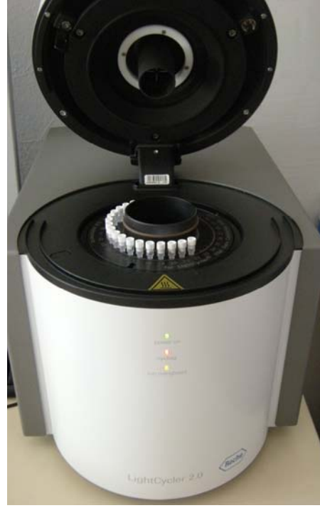
Sekil: LightCycler 2.0 iç kısım şematik görüntüsü Resim16: RT-PCR cihazı (LightCycler® 2.0, Instrument, Roche)
