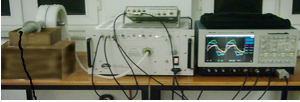
Şekil 3.1. Yalıtkan Engel Deşarjının oluşturulduğu deney düzeneği
