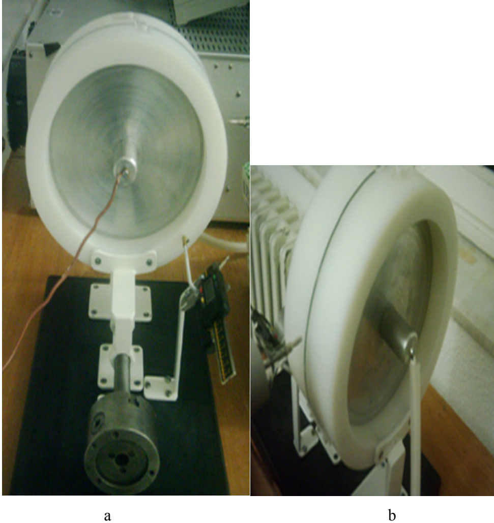
Şekil 3.3. Elektrot sisteminin a) soldan görünümü (topraklama yapılan elektrot) b) sağdan görünümü (yüksek gerilime bağlanan elektrot)
