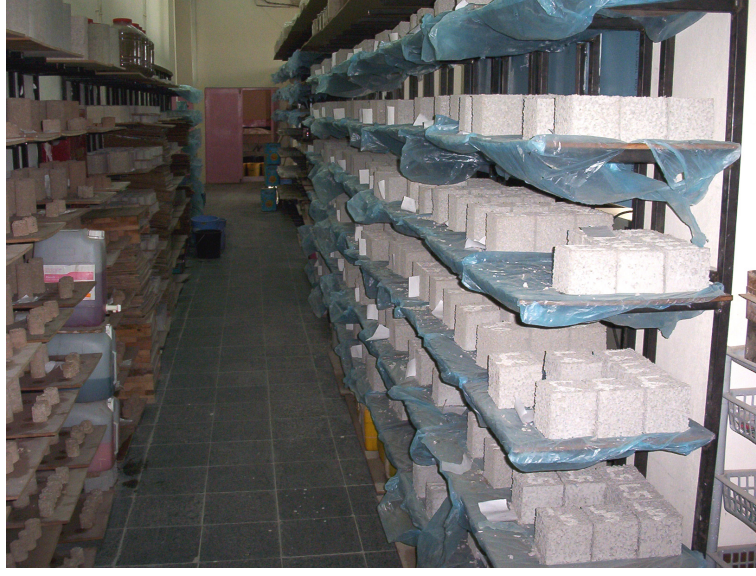
Şekil 3.3. Hafif beton numuneleri (a)
