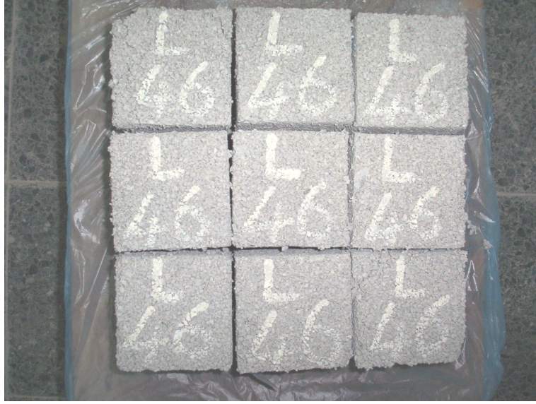
Şekil 3.10. Hafif beton numuneleri (b)
