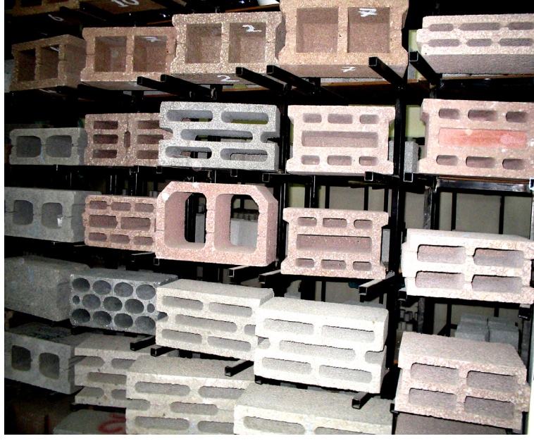
Şekil 2.1. Değişik geometrik boyutlarda üretilmiş bimsblok örnekleri
