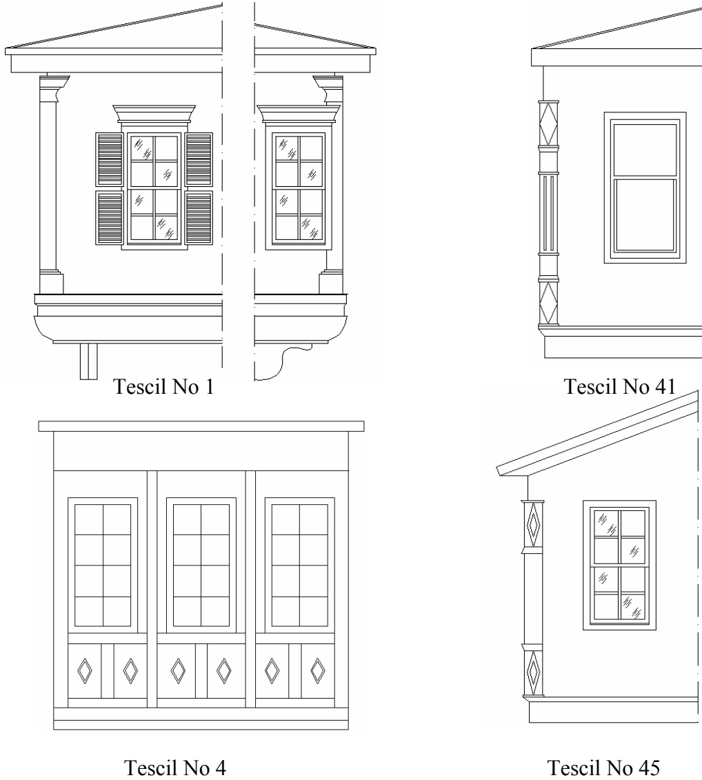
Şekil 3.2.3.1. Tescilli Konutlarda Çıkma Örnekleri (Çizen: Kayalı,B. 2004)
