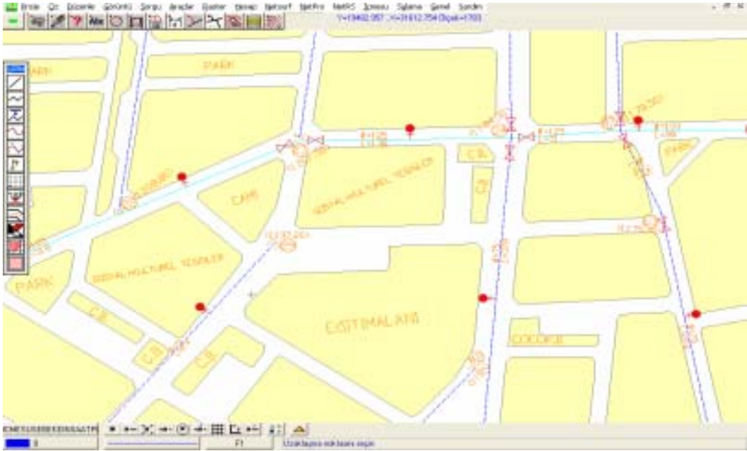
Şekil 4.5. Tüm sayısalılaştırma işlemleri sonunda içmesuyu şebekesi
