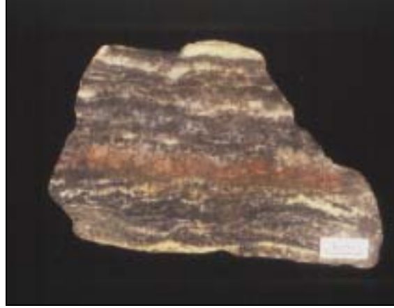
Şekil 4.7 Murgul Anayatak açık madeninden alınmış iyi derecelenmiş dissemine tipi cevherleşme (Özgür, 1993).
