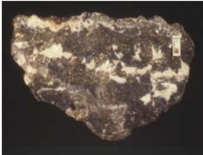
Şekil 4.9 Murgul Çakmakkaya açık madeninden alınmış küçük cevher damarları şeklindeki cevherleşme (Özgür, 1993).
