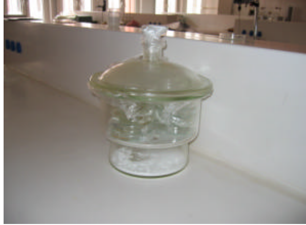
Sekil. 3.2.2.1.3. İçinde nem çekici maddelerin bulunduğu desikatörde çiçek tozlarının saklanması.
