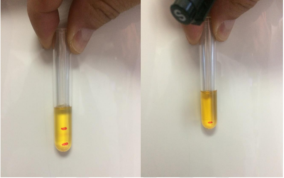
Şekil 17. Soldaki resim plazmanın konsantre edildikten sonraki 3 bölgeye ayrılmış halini gösterir, sağdaki resim ise tüpün dip kısmındaki yaklaşık 300 \mu L hacmindeki PCP kısmını göstermektedir (kırmızı çizginin altında hacim yaklaşık 300 \mu L).
