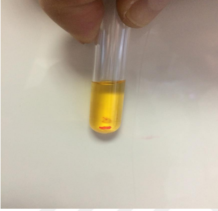
Şekil 19. Santrifüj işleminden sonra (plazmanın son konsantre aşaması) tüpün dibinde plateletlerin en yoğun olduğu 100 \mu L hacmindeki kısım. Kırmızı çizginin üstü PPP kısmını ifade etmektedir.
