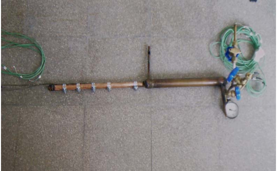
Şekil 3.4. Isı borusu üzerinde sıcaklık ölçme elemanlarının yerleri
