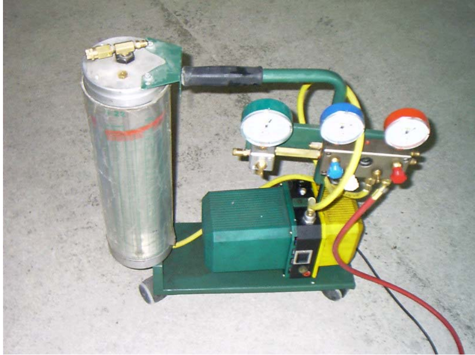
Şekil 3.10. Isı borularının vakuma alınmasında kullanılan vakum pompası
