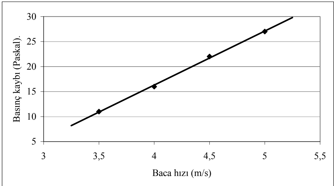
Şekil 4.43. Isı borulu ısı geri kazanım sisteminin neden olduğu basınç kaybı
