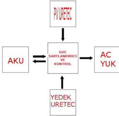
Şekil 3.28. Bağımsız bir PV sistemin temel bileşenleri ve güç akış yönleri görülmektedir.
