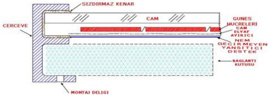
Şekil 3.24. Modülün fiziksel yapısı (Photovoltaic Systems, 2000).
