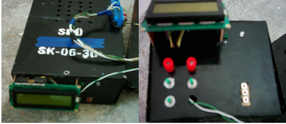
Şekil 3.75. a) Gerçekleştirilen kontrol ünitesi. b) kontrol ünitesi LCD ekranı
