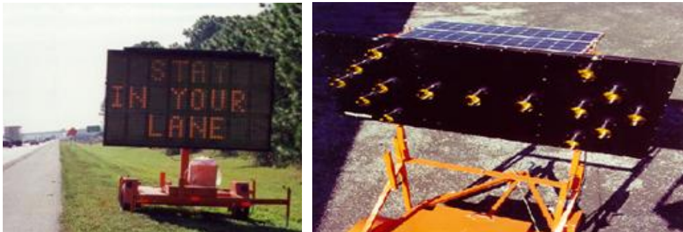
Şekil 3.36. Trafikte ulaşım güvenliğini sağlamakta kullanılan güneş pilli ışıklı ikaz sistemlerinden görünüm.
