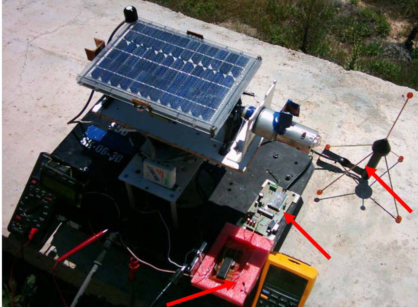
Şekil 3.92. Sisteme sıcaklık ve kablosuz veri aktarımının ilave edilmiş görünümü.
