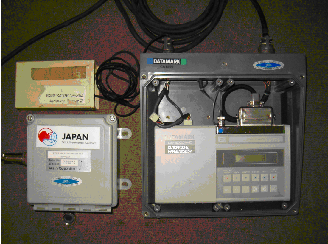
Şekil 8. Akashi marka JEP-6A3 model sismometre. Frekans Bandı 0,2-20 Hz düz duyarlılık 1 V/G.
