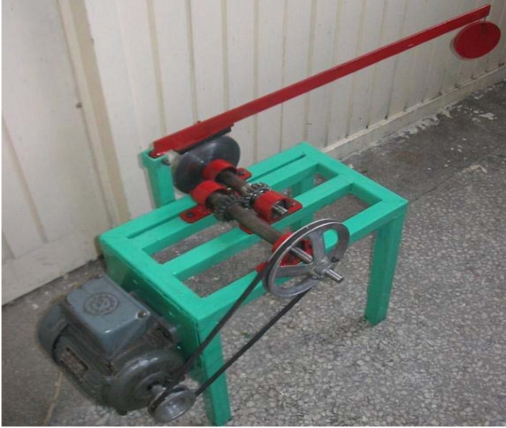
Şekil 3.7. Aşınma deney düzeneğinin fotoğrafı
