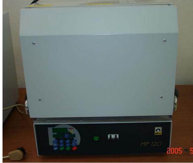
Şekil 3.1. Nüve firmasına ait kül fırını
