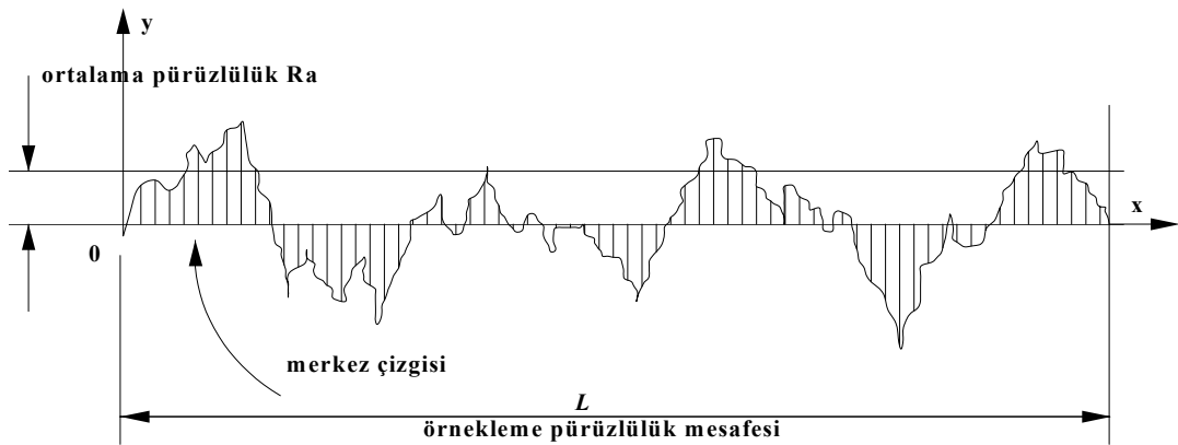
Şekil 2.5.1.1. R_a yüzey pürüzlülük değerinin gösterimi
