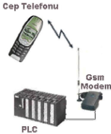
Şekil 1.10. Cep Telefonu – Gsm Modem – Plc Bağlantısı
