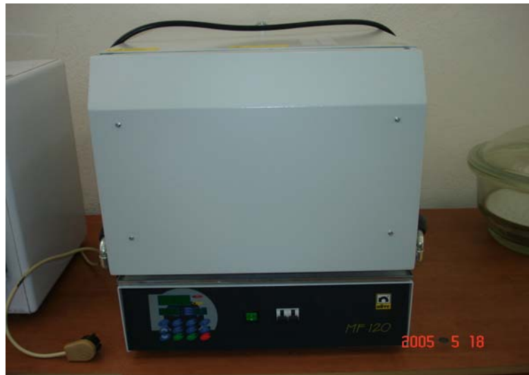
Şekil 3.3. Deneyde kullanılan kül fırını
