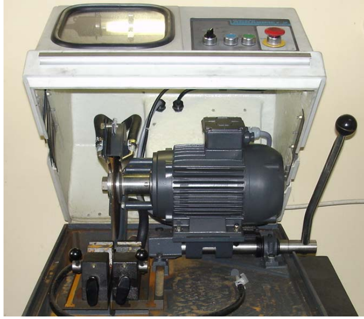
Şekil 3.4. Numunelerin kesilmesinde kullanılan hassas kesme cihazı
