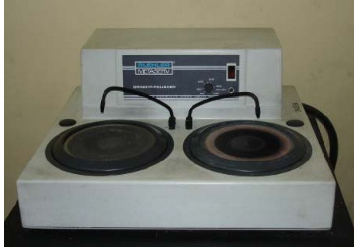
Şekil 3.5. Numunelerin parlatılmasında kullanılan parlatma cihazı
