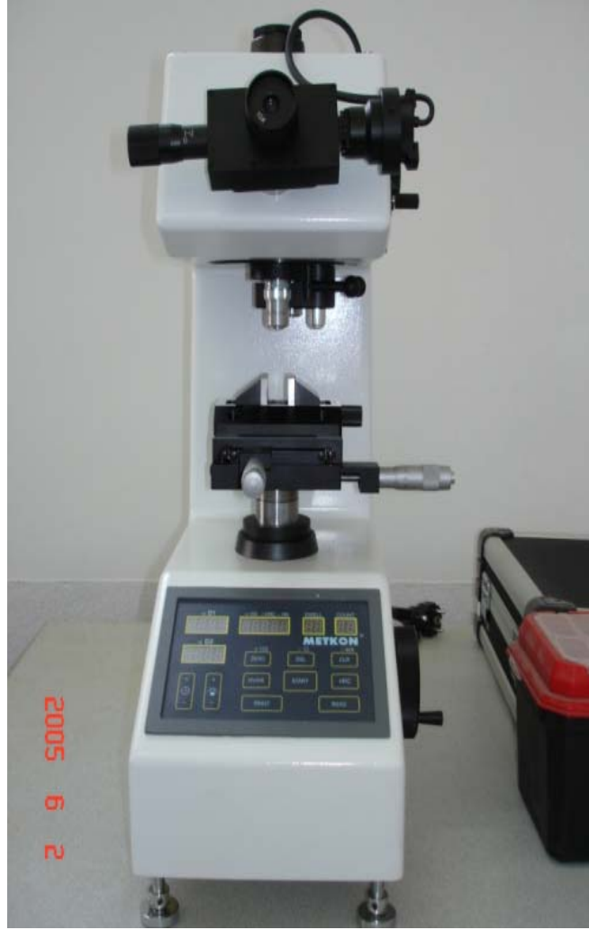
Şekil 3.7. Sertlik ölçme cihaz
