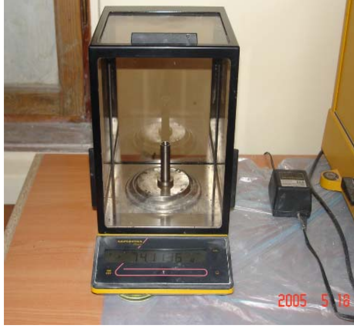
Şekil 3.13. Aşınma tespitinde kullanılan hassas terazi
