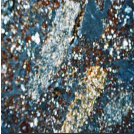
T9 (Kuvars, Feldspat (Albit, Anortit), Metamorfik Kayaç Kırıntısı (Biotit), Hematit)
