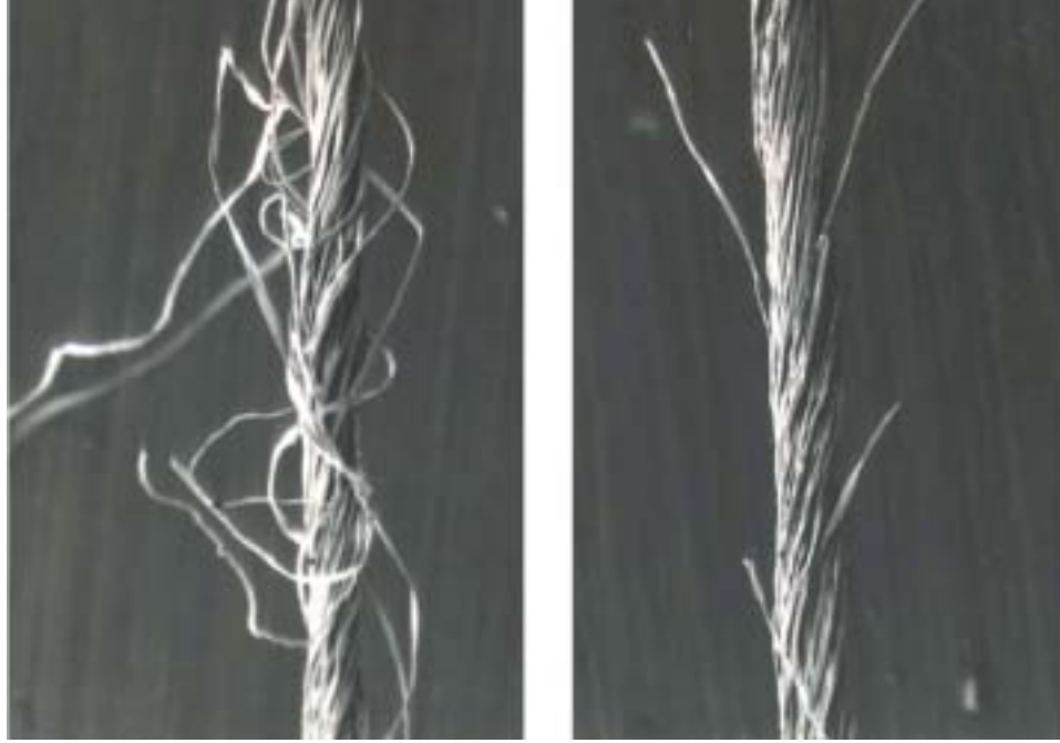
Şekil 4.15 Konvansiyonel ring ve kompakt iplik yapıları (Rieter, 2002)
