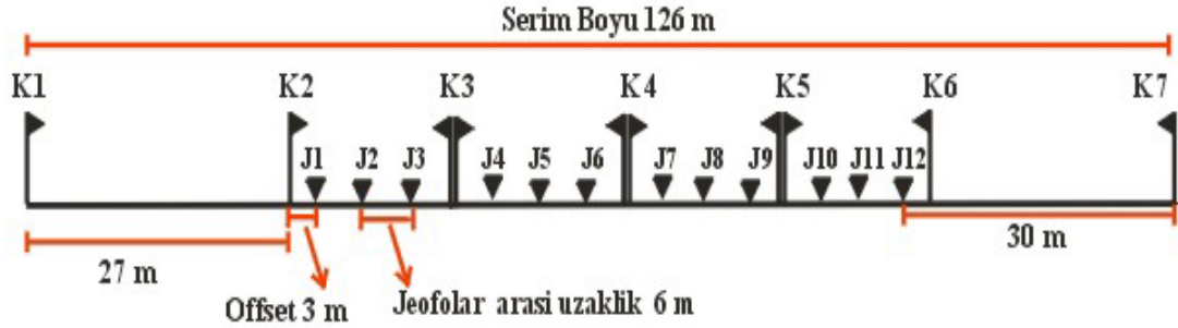
Şekil 4.17 Sismik kırılma sisteminde çoklu atış serim düzeni
