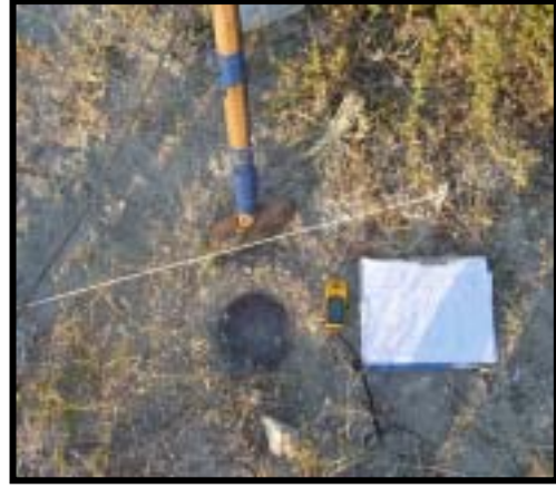
Şekil 4.2 P kaynağı, balyoz, GPS
