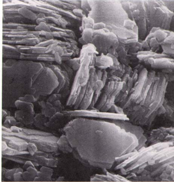
Şekil 2.5. Kaolinitin elektron fotomikrografı (17µm) (Mitchell, 1976)
