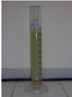
Şekil 3.2. Serbest şişme indisi deneyi
