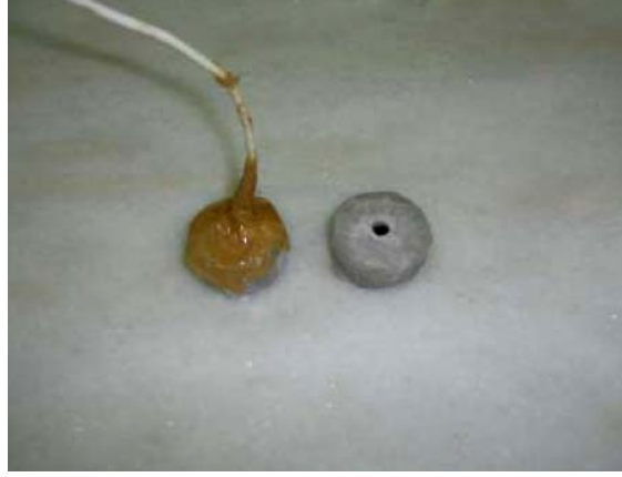
Şekil 3.11. Saykrometre deney numunelerinin hazırlanması
